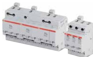
ABB ofrece una amplia gama de protectores contra sobretensiones diseñados para sistemas fotovoltaicos. Entre sus principales características están: protección IEC tipo 1 (corriente impulso 6,25kA) o tipo 2 (corriente máxima 40kA), auto-protección contra cortocircuitos al final de su vida útil de hasta 100 kA, cartuchos enchufables para facilitar el mantenimiento, señalización remota y configuración en "Y" para una protección más segura.
