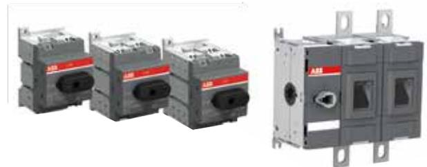
La gama de interruptores-seccionadores OTDC está disponible en corrientes nominales desde 16A hasta 32A (3 versiones modulares) y de 100A hasta 500A en configuración de dos polos, todas hasta 1000Vcc. Hay disponibles versiones de cuatro polos (1500 VCC) o de doble dispositivo (dos seccionadores que trabajan simultáneamente con una sola palanca, cada uno seccionando circuitos de 1000V).
