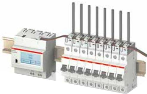
Este sistema, fácil de integrar, permite detectar de inmediato un string defectuoso o sombreado, e implementar rápidamente una solución apropiada. Rango de corriente 20, 40, 80, y 160A. Hasta 96 sensores por controlador. Tensión de aislamiento 1500Vcc.
