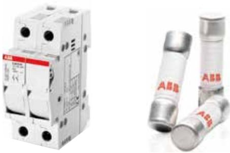
Las bases porta fusibles seccionadoras de la serie E 90 PV se han diseñado para una tensión de corriente continua de hasta 1000 V, categoría DC-20B. Una solución fiable, compacta y económica porque emplean fusibles E9F PV cilíndricos de 10,3 x 38 mm, con característica gPV
